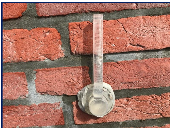
Afbeelding: Proefbelasting m.b.v. een Kartentest toont aan dat er oppervlakkige vochtname plaats vindt.
